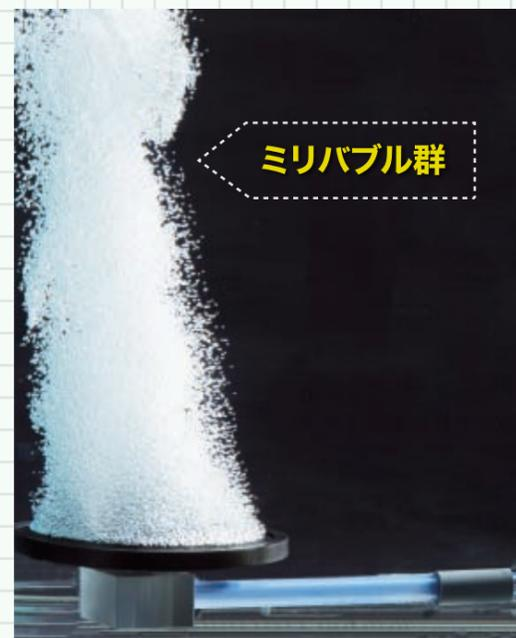
見た目は良さそうに見える。しかし、上昇するスピードが遅いため、槽内循環流を形成できず、どうしても汚泥が槽底に堆積してしまう
